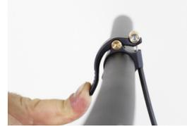
Man sollte jetzt beim Betätigen des Bedienhebels auf den letzten 2 bis 3 Millimetern des Hebelwegs einen erhöhten Widerstand spüren.
