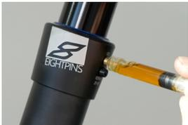
Eightpins Fluid V3 mit einer 2,5ml Spritze vorsichtig und sehr langsam in über den Abschmiernippel in das Außenrohr einfüllen.
