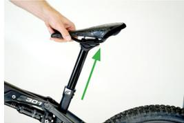
Bevor die richtige Höhe des Sattels eingesellt werden kann muss die interne hydraulische Gasdruckfeder der Sattelstütze komplett ausgefahren sein. Dazu einfach den Bedienhebel am Lenker betätigen und die Sattelstütze komplett ausfahren lassen.
