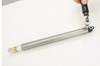
Beide Madenschrauben mit einem Drehmoment von 3Nm fest ziehen.
