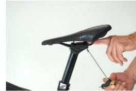
Beim Anziehen der Sattelklemmschrauben mit dem Finger die Sattelklemmmuttern nach unten drücken, so dass sie vollständig in der oberen Sattelklemmplatte verschwinden.
