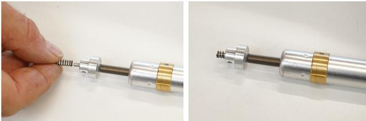
Am Ende der Kolbenstange befinden sich der Montageadapter und der Betätigungsstößel der Gasdruckfeder. Hier die Druckfeder heraus ziehen und zur Seite legen. Diese wird später für den Einbau der neuen Gasdruckfeder wieder benötigt.
