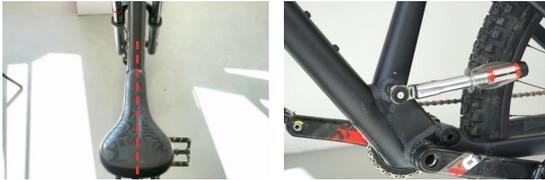
Nach der Sattelmontage muss der Sattel rotativ in Fahrtrichtung ausgerichtet werden. Am besten mit der Sattelspitze am Oberrohr orientieren. Danach die Postpin Achse mit einem Drehmomentschlüssel mit 8Nm fest ziehen.
