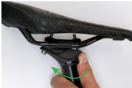
Betätigung für Höhenverstellung wieder nach hinten in die geschlossen Stellung schieben.
