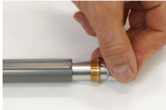
Jetzt die Gasdruckfeder vorsichtig wieder in die Kartusche schieben. Dabei darauf achten, dass die Nut im Drehmoment-Messingring mit der Feder/Führung innerhalb den Kartuschenrohrs fluchtet.
