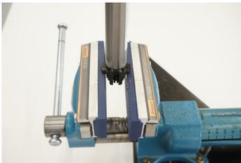
Die Kartusche mit einem Schraubstock an der Befestigungsschnittstelle der Postpin Achse links und rechts klemmen.
