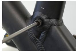
Die Sattelstütze so weit nach unten drücken bis die Postpin Montageschnittstelle der Sattelstütze die Postpin Schnittstelle des Rahmens erreicht. Das kann man von außen erkennen, wenn man in das Loch der Postpin Schnittstelle des Rahmens blickt. Die Sattelstütze bei Bedarf etwas drehen und zurecht schieben, damit die Postpin Achse eingeführt werden kann. Die Postpin Achse mit einem 5mm Inbus einschrauben und noch locker anziehen.
