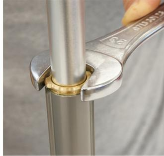
Mit dem 23mm Gabelschlüssel vorsichtig die obere Messingführung aus der Kartusche heraus drehen. Darauf achten, dass die Längsführungen der Kartusche nicht in Eingriff mit dem Gabelschlüssel stehen und somit nicht beschädigt werden.
