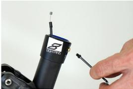
Befestigungsschraube der Außenhülse mit einem 3mm Inbus Schlüssel heraus drehen.
