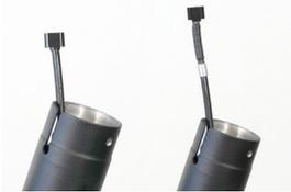
Zur Fixierung der Außenhülle an der breiten Montageschnittstelle der H01 Sattelstütze wird eine spezielle Endkappe benötigt. In Fahrrädern ohne E-Antrieb wird ausschliesslich die Spezialendkappe benötigt (linkes Bild). Fahrräder mit E-Antrieb haben wenig Platz zwischen Motor und Sattelstütze für den Abgang des Seilzugs. Hier kommt eine spezielle Kugelflex-Außenhülle zum Einsatz (rechtes Bild). Diese wird zwischen Außenhülle und Spezialendkappe montiert.
