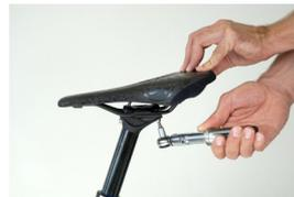
Die hintere Befestigungsschraube am Sattelstützenkopf mit einem 5mm Inbus lockern.
