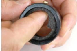
Den Filzring vorsichtig mit der Hand in die Nut drücken. Darauf achten, dass beide Enden Stoss auf Stoss voll eingepresst sind und nicht überlappen oder verdreht sind.
