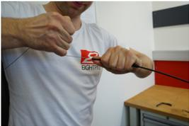
Bevor der Seilzug montiert wird, fest am Seilzug ziehen bis die Rastmechanik vollständig geöffnet ist. Man hört beim öffnen ein leises klicken aus dem inneren des Sattelrohrs. Beim auslassen schnappen die Rasten der Mechanik wieder auseinander. Das Vorspannen ist wichtig, um sicher zu gehen, dass alle Verbindungen des Seilzugsystems fest sitzen.
