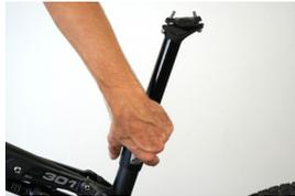
Die Sattelstütze jetzt vorsichtig in den Rahmen einführen bis die Gleitbuchse ins Sattelrohr gleitet. Die Außenhülle mit der Hand vorsichtig auf das Sattelrohr aufpressen bis die Außenhülle fühlbar auf Anschlag geht.
