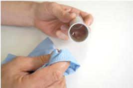
Gleitbuchsenrohr mit einem feuchten Tuch vorsichtig reinigen.
