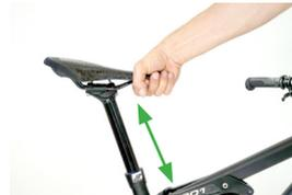
Den Hebel für die Höhenverstellung von hinten nach vorne schieben zum öffnen der Höhenverstellung. Jetzt den Sattel durch nach oben ziehen oder nach unten drücken in die gewünschte Höhe bringen.
