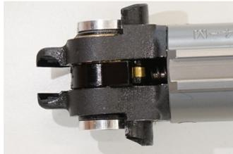
Die Gasdruckfeder soweit hinein schieben, bis der Stößel und die Feder beim Betätigungsmechanismus an der Montageschnittstelle anstehen. Das kann man von außen sehen wenn man zwischen den Umlenkhebel und das Kartuschenrohr blickt.
