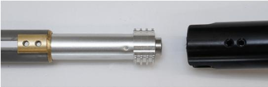
Die Längsführungsschuhe mit Fett einschmieren und am Ende der Längsführungen auflegen. Kartuscheneinheit wieder in das Sattelstützenrohr einführen. Dabei auf die Orientierung der Kartusche achten. Die Längsführungsschuhe müssen mit den Löchern im Sattelstützenrohr fluchten.
