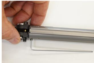
Die Madenschrauben zu Befestigung der Gasdruckfeder mit hochfester Schraubensicherung versehen und in die Löcher der Montageschnittstelle einschrauben. Während des einschraubens der ersten Schraube muss die Gasdruckfeder in die Kartusche gedrückt werden. Beide Madenschrauben bis auf Anschlag hinen drehen.
