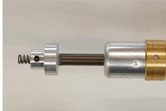
Vor dem Einbau der neuen Gasdruckfeder muss die Stellung des Montageadapters überpüft und gegebenenfalls nachjustiert werden. Die Löcher im Montageadapter müssen mit den Löchern des Drehmoment-Messingring in Flucht gebracht werden. Dazu den Montageadapter durch drehen auf die Löcher ausrichten. Dabei dreht sich die komplette Kolbenstange mit. Die Druckfeder für die Stößelbetätigung auf den Stößel aufstecken.
