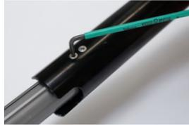
Die vier Montageschrauben für die Längsführungsschuhe mit mittelfester Schraubensicherung betropfen und vorsichtig einschrauben. Am besten zuerst eine Seite und dann durch einschieben oder heraus ziehen der Kartuscheneinheit den Längsführungsschuh auf der anderen Seite auf die Löcher ausrichten und fest schrauben.
