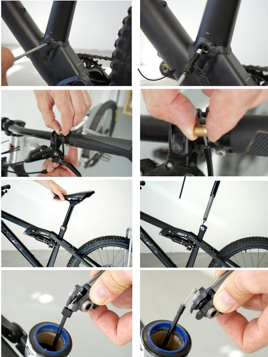
Mit einem 5mm Inbus Schlüssel die Postpin Achse heraus schrauben.
