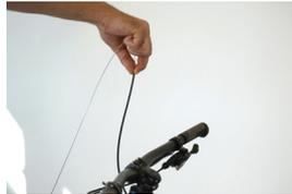
Die Außenhülle und die Gleitbuchse zur einfacheren Montage nach unten schieben. Während des gesamten Einführens der Sattelstütze in das Sattelrohr des Rahmens muss der Seilzug gespannt bleiben. Am besten den Seilzug gemeinsam mit der Außenhülle an dessen Ende festhalten. Während des Einführens leicht an der Außenhülle ziehen, so dass diese durch den Rahmen rutschen kann.
