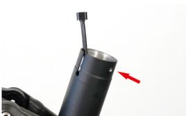
Der Rahmen muss am oberen Ende ein 5mm Loch aufweisen für die Schraub Befestigung der Außenhülle. Sollte dieses Loch nicht vorhanden sein, lesen Sie in der Betriebsanleitung ihres Rahmens nach, wie dieses Loch in das Sattelrohr des Rahmen eingebracht werden kann.
