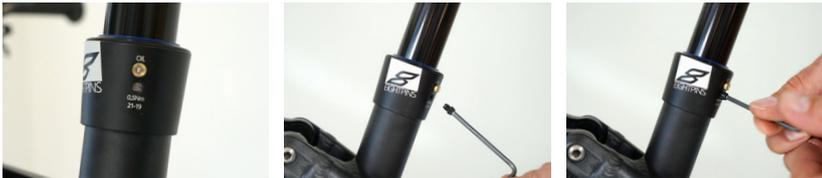
Die Außenhülse durch Rotation so zurecht drehen, dass sich das Montageloch der Außenhülse mit dem Befestigungsloch am Rahmen deckt. Die M5 Montage Schraube der Außenhülse mit einem 3mm Inbus Schlüssel in die Außenhülse einschrauben.
