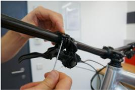
Bedienhebel zwischen Griff und Bremshebel auf dem Lenker montieren. Befestigungsschraube mit einem Drehmoment von 2,5Nm fest ziehen.
