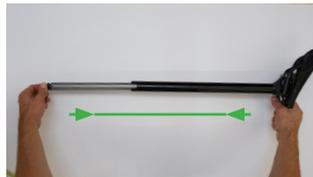
Längsführungsnuten der Sattelstütze mit einem feuchten Tuch reinigen.
