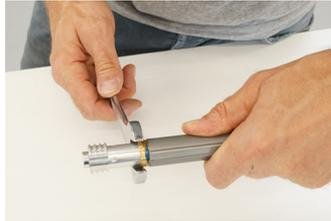
Die Messingführung vorsichtig in das Rohr der Kartusche hinein drehen. Bei Schwergängigkeit eventuell wieder den 23mm Gabelschlüssel zur Hilfe nehmen.
