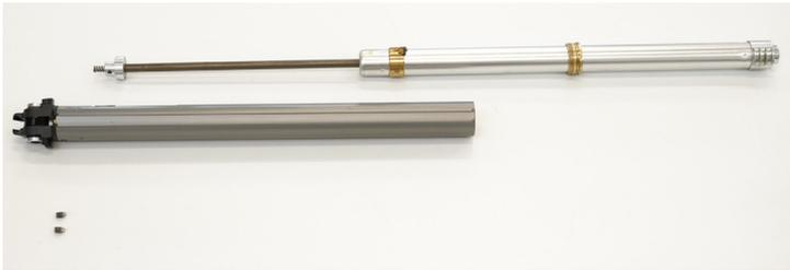
Wenn beide Schrauben gelöst sind, kann die Gasdruckfeder aus der Kartusche herausgezogen werden.
