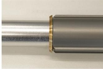
Vor dem Wiedereinbau der Kartusche, das Gehäuse der Gasdruckfeder mit Fett einschmieren.
