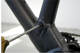
Die Postpin Achse mit einem 5mm Inbus einschrauben und noch locker anziehen.
