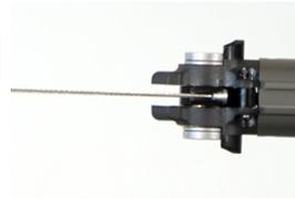
Seilzkopf in den Hydraulik-Betätigungshebel der Sattelstütze einhängen
