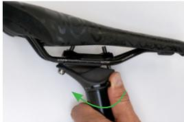
Sattelstütze wieder zusammen schieben und Hebel für die Höhenverstellungsbetätigung wieder nach hinten in die geschlossene Stellung schieben.
