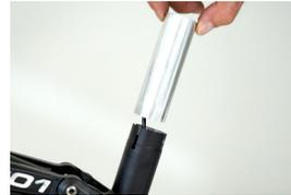
Gleitbuchsenrohr aus dem Sattelrohr heraus ziehen.
