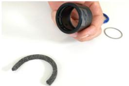
Den Filzring reinigen oder ersetzen.
