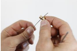
Die Seilzugklemme des Bedienhebels auf den Seilzug aufstecken und bis zur Endhülse führen.
