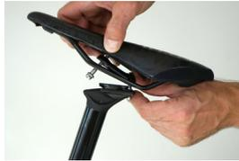
Beide Sattelklemmschrauben lösen und die vordere Sattelklemmschraube nach vorne hin aushängen. Obere Sattelklemmplatte anheben und oberhalb der beiden Sattelgestellstangen positionieren.
