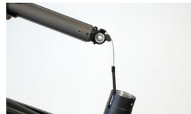
Seilzug in die Außenhülle einführen und fast komplett hinein schieben.
