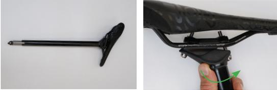
Betätigungshebel für Höhenverstellung nach vorne in die „geöffnet“ Stellung schieben.
