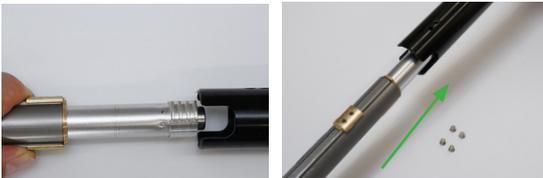
Die Kartuscheneinheit mit den Längsführungsschuhen soweit in das Sattelstützenrohr einführen bis sich die Löcher mit den Schraubenlöchern der Längsführungsschuhe decken.
