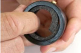
Den Filzring innerhalb der Außenhülse aufrollen, so dass er auf der Nut aufliegt.
