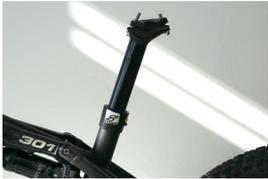
Bevor die Postpin Achse fest gezogen wird, muss der Sattel zur Ausrichtung der Sattelstütze montiert werden.
