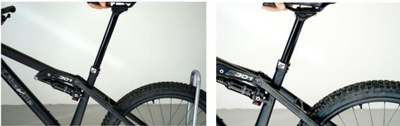
Die Sattelstütze so weit nach unten schieben bis die Postpin Montageschnittstelle der Sattelstütze die Postpin Schnittstelle des Rahmens erreicht. Das kann man von außen erkennen, wenn man in das Loch der Postpin Schnittstelle des Rahmens blickt. Die Sattelstütze bei Bedarf etwas drehen und zurecht schieben, damit die Postpin Achse eingeführt werden kann.
