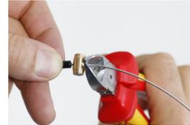
Dann das Seil mit einem Seitenschneider direkt an der Seilzugklemme abschneiden.
