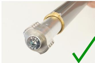
**Achtung! Es ist dringend notwendig, dass die Messingführung verbaut wird und die Nasen richtig ausgerichtet sind. Ansonsten kann das Rad während es am Sattel aufgehängt wird runter fallen. Es besteht hohes Verletzungsrisiko!**
