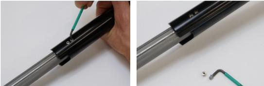
Die vier Befestigungsschrauben der Längsführungsschuhe mit einem 2mm Inbus Schlüssel heraus schrauben.
