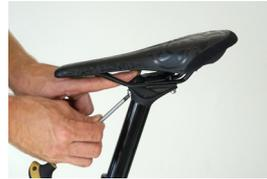
Sattelgestellstangen auf der unteren Sattelklemmplatte aufliegen lassen und die vordere Sattelklemmschraube wieder einhängen. Beide Sattelklemmschrauben locker anziehen.
