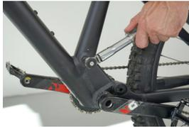
Nach der Sattelmontage muss der Sattel rotativ in Fahrtrichtung ausgerichtet werden. Am besten mit der Sattelspitze am Oberrohr orientieren. Die Postpin Achse mit einem Drehmoment Schlüssel mit 8Nm fest ziehen.
