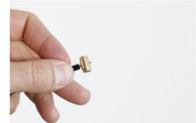
Die Seilzugklemme wieder ein wenig von der Endkappe wegziehen, sodass das Ende des Seils in der Seilzugklemme verschwindet.
