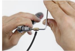
Mit einem 3mm Inbus und einem Drehmomentschlüssel mit 3mm Inbus Bitaufsatz beide Schrauben der Seilzugklemme simultan mit 5Nm fest ziehen.
